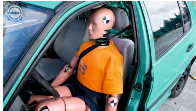
Počas nárazu vozidla do stĺpa nebola bezpečnostná zóna vodiča v kabíne narušená.
