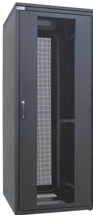
Rozvádzač SZB SE 42 U, 800x1000 mm, RAL 9005, perforácia dverí typu B na nožičkách, 2 páry nosných lišt. Symbol: WZ-SZBSE-005-6J11-11-0000-2-161
