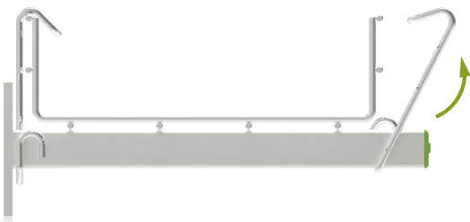
5. Dotlačenie spodnej časti spony a zapnutie horného háku spony na drôtený žľab
