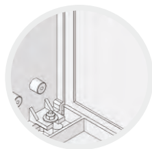
Typ B (zadná strana bez izolátora) Type B (no insulator in the back wall) Typ B (kein Isolator auf der Rückseite) Тип B (отсутствие изолятора на задней стене корпуса)
