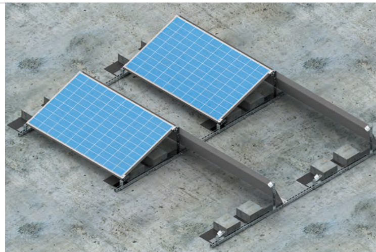
PRÍKLAD JEDNOSTRANNEJ MONTÁŽE, konštrukcie bez narušenia izolácie strechy - zaťažená, nasmerovaná na juh DPB-20°
