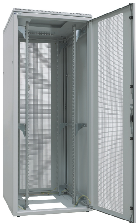
Rozvádzač SZB SE 42 U, 800x1000 mm, RAL 7035, perforácia dverí typu B na nožičkách, 2 páry nosných lišt. Symbol: WZ-SZBSE-005-6J11-11-0000-2-011
