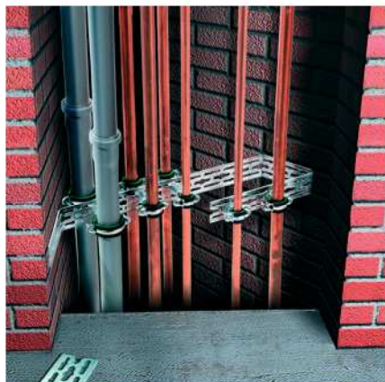
Montáž v šachtě: zásuvná montáž se dvěma objímkami a jednou závitovou tyčí M8 nebo M10 pro upevnění paralelně vedených potrubí
