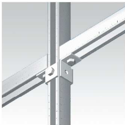
Stavba regálu s uzlovým bodem z MPC-nosníků s napojením do 2 směrů
