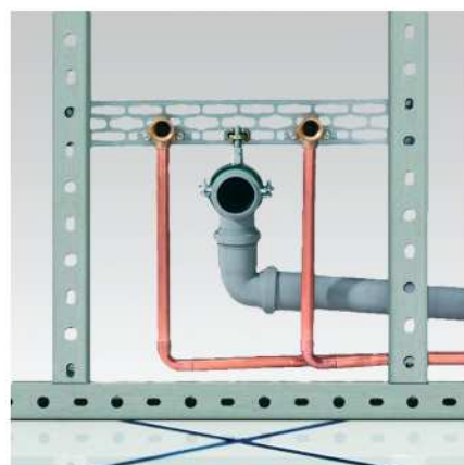
Předstěnová instalace: Předstěnová instalace s prvky Stabo-Fix® v kombinaci s MPC-nosníky
