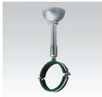
Při velké vzdálenosti od stěny lze v kombinaci s redukcí trubkového/metrického závitu a trubkové vsuvky použít jako kluzné uložení
