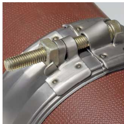
Optická kontrola: Po dotažení potrubní spojky: kontrolní spára musí být uzavřená
