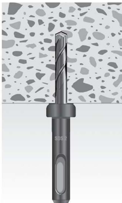
Vrtání s vrtákem s nákrůžkem MPC.
