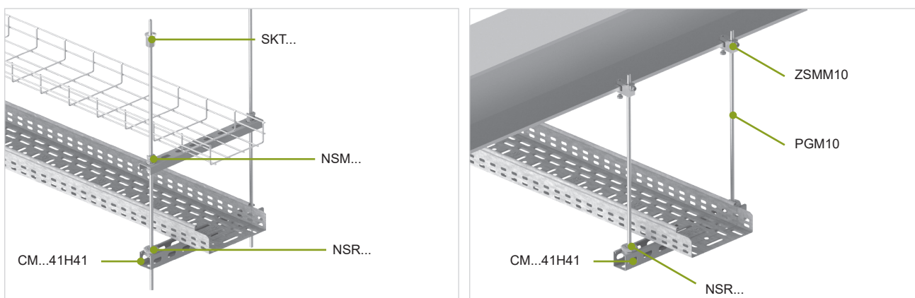
Príklad použitia dosky C-uholníka PZC a matice zosilnenej NW...
